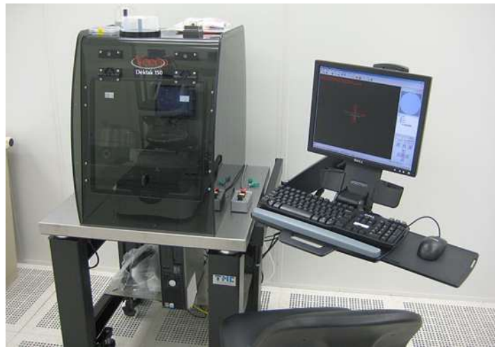
Figura 4.3. Dispozitivul utilizat pentru determinarea rugozității suprafeței
